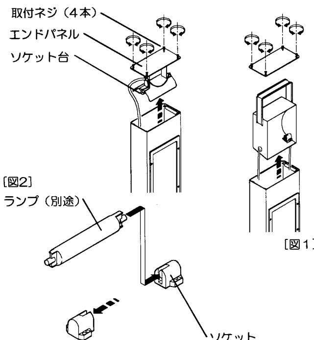
1. 取付ネジをゆるめエンドパネルをはずします。[図1]
