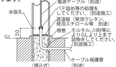
必ずコンクリート等で、ポールの埋込部を補強してください。
