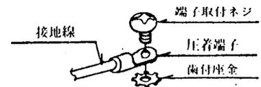
※接地線を圧着端子接続(圧着)して下さい。
