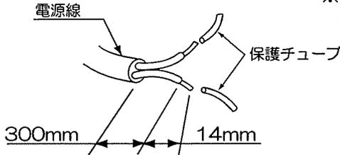
②電源線を電源用端子台のゲージ（14mm）に合わせます。
