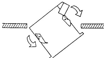
③枠を天井面に押し当てるながら取付金具を引きさげます。
