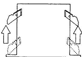
②取付金具を押さえながら、本体をソケット側から先に取付穴に挿入します。
