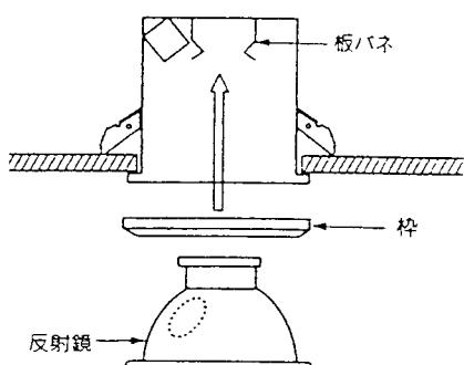
枠の中を通しながら反射鏡を押し上げ、天頂部の四角穴にしっかりと板バネにはめこみます。
