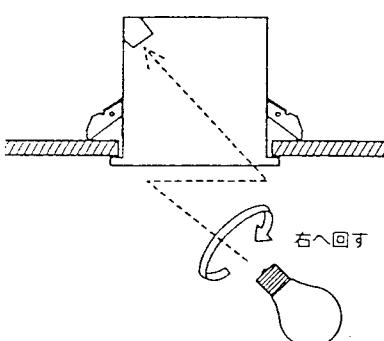
ランプをソケットの口金に合わせて時計方向にまわし、取付けます。
