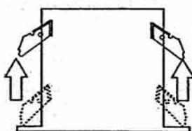
②取付金具を押さえながら、本体を安定器側から天井に挿入します。
