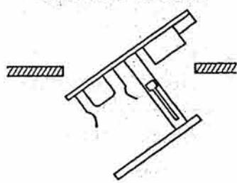
③枠を天井面に押し当てるながら取付金具を引きさげます。
