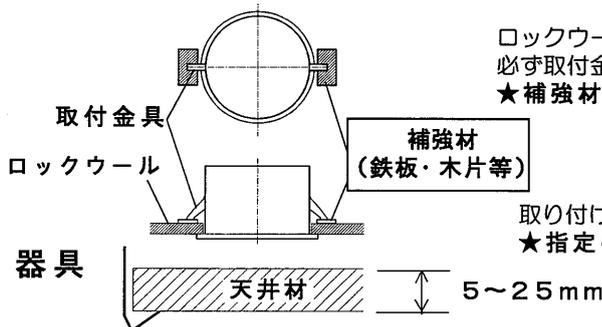
ロックウールなどの柔らかい材料を使用している天井に取り付ける場合には、必ず取付金具と天井材の間に補強材(鉄板・木片等)を入れてください。
