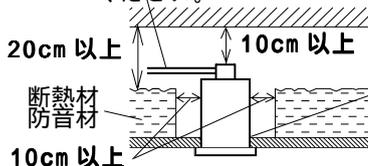
断熱材・防音材で本体の放熱孔穴等をふさがらないでください。
