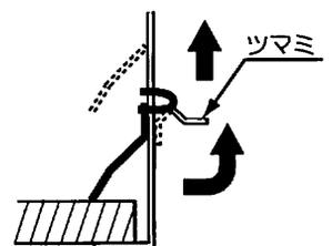
ツマミを⊖ドライバー等でゆるめて上の方へ引き上げてはずしてください。
