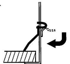
⑤反射鏡を1, 2の順でセットしたのち、反射板止ナットで本体にしっかりと取り付けてください。
