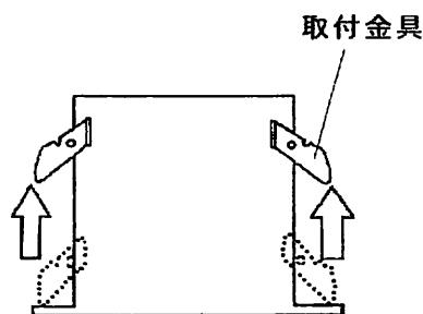
②取付金具を押さえながら本体を垂直に立て、電源・速結端子側から天井内に挿入します。
