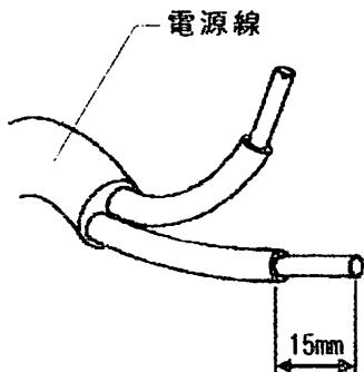
②電源線を速結端子のゲージ(15mm)に合わせ剥きます。
