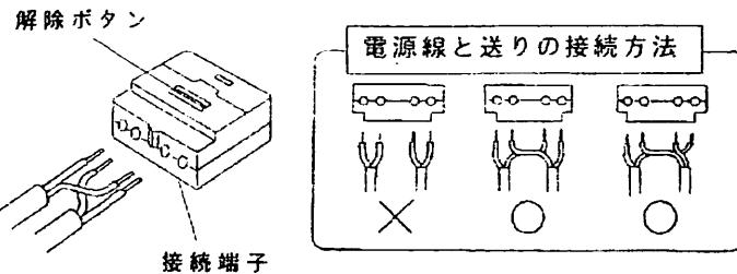
**△警告!** 端子に差し込むケーブルは、必ずVV-FΦ1.6またはΦ2.0の単線ケーブルで真っ直ぐな線を使用してください。
