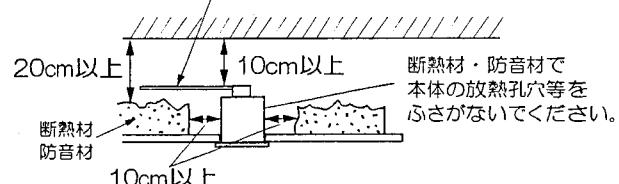
温度の高くなるもの(ガスレンジやエアコンの吹出しが)の近くに設置しないでください。
