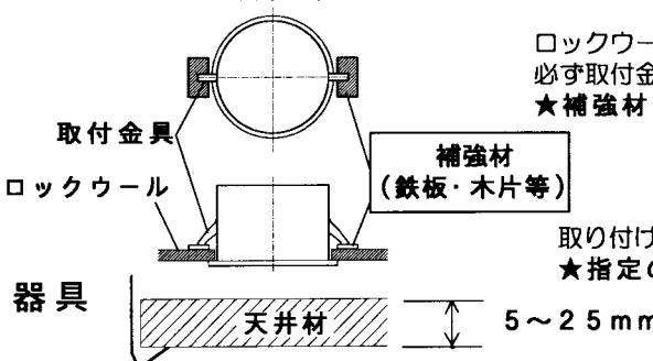
ロックワールなどの軟らかい材料を使用している天井に取り付ける場合には、必ず取付金具と天井材の間に補強材(鉄板・木片等)を入れてください。
