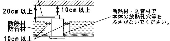
断熱材・防音材で本体の放熱孔穴等をふさがないでください。
