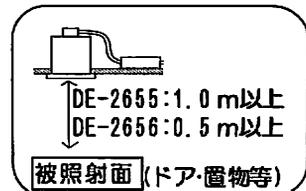
一住宅以外の断熱施工天井でご使用の場合の施工方法一
