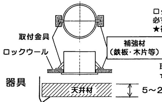
ロックワールなどの柔らかい材料を使用している天井に取り付ける場合には、必ず取付金具と天井材の間に補強材(鉄板・木片等)を入れてください。
