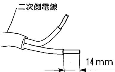
②二次側電線・アース線を電源用端子台のゲージ (14mm) に合わせ剥きます。
