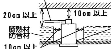
断熱材・防音材で本体の放熱孔穴等をふさがないでください。
