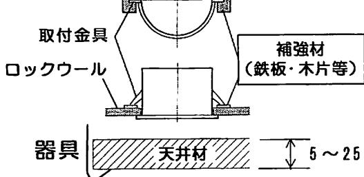
ロックワールなどの軟らかい材料を使用している天井に取り付ける場合には、必ず取り付け金具と天井材の間に補強材（鉄板・木片等）を入れてください。
