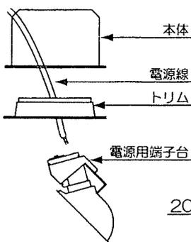
①電源線の被覆を剥ぎ、保護チューブを被せます。
