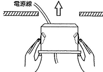
③枠を天井面に押し当てながら取付金具を引き上げます。
