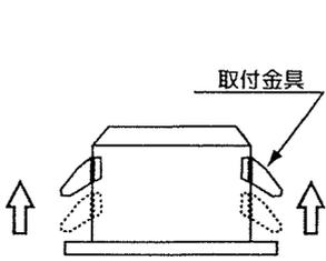
②取付金具を押さえながら電源線を通し天井内に挿入します。
