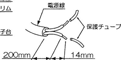
②電源線を電源用端子台のゲージ (14mm) に合わせます。
