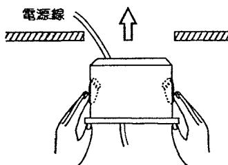
③枠を天井面に押し当てながら取付金具を引きさげます。
