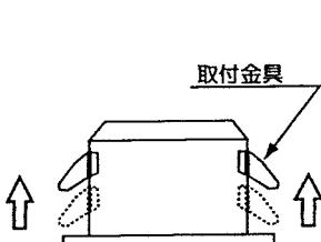
②取付金具を押さえながら電源線を通し天井内に挿入します。
