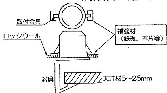
ロックワールなど柔らかい材料を使用している天井に取り付ける場合には、必ず天井材との間に補強材(鉄板、木片等)を入れてください。
