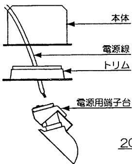
②電源線を電源用端子台のゲージ (14mm) に合わせます。
