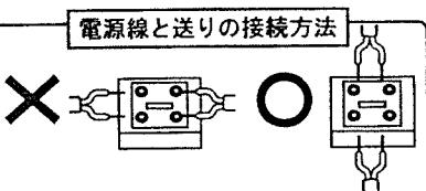
適合電線 Cu $\phi$ 1.6mm
