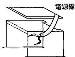
②電源線の被覆を剥ぎ、保護チューブを被せます。
