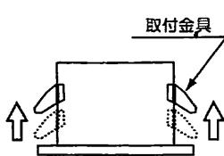
②取付金具を押さえながら天井内に挿入します。
