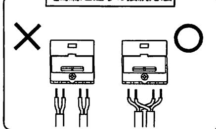
**△注意** ! 端子台に差し込むケーブルは必ずVVF ø1.6またはø2.0の単線ケーブルで真っ直ぐな線を使用してください。
