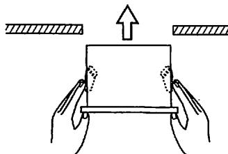
③枠を天井面に押し当てるながら取付金具を引きさげます。
