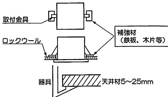
ロックワールなど軟らかい材料を使用している天井に取り付ける場合には、必ず取り付け金具と天井材の間に補強材(鉄板、木片等)を入れてください。
