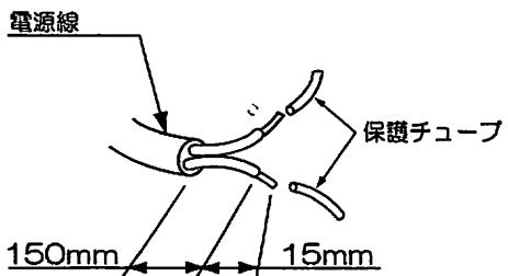
③電源線を電源用端子台のゲージ (15mm) に合わせます。
