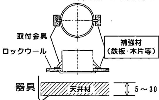
ロックウールなどの軟らかい材料を使用している天井に取り付ける場合には、必ず取り付け金具と天井材の間に補強材(鉄板・木片等)を入れてください。
