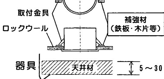
ロックワールなどの軟らかい材料を使用している天井に取り付ける場合には、必ず取り付け金具と天井材の間に補強材(鉄板・木片等)を入れてください。
