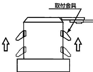
②取付金具を押さえながら天井内に挿入します。
