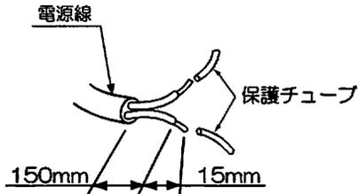
②電源線を電源用端子台のゲージ（15mm）に合わせます。
