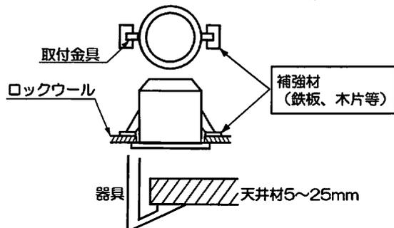
ロックワールなど柔らかい材料を使用している天井に取り付ける場合には、必ず天井材との間に補強材(鉄板、木片等)を入れてください。
