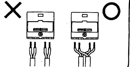
**△警告** ① 端子台に差し込むケーブルは必ずVVVFΦ1.6またはΦ2.0の単線ケーブルで真っ直ぐな線を使用してください。
