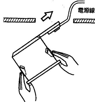
③本体を天井面に押し当てるながら取付金具を引き上げます。
