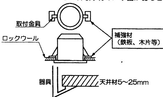
ロックワールなど柔らかい材料を使用している天井に取り付ける場合には、必ず天井材との間に補強材(鉄板、木片等)を入れてください。
