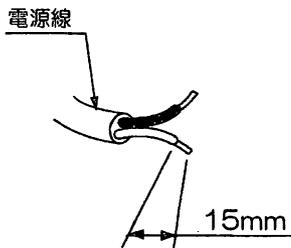
②電源線を電源用端子台のゲージ(15mm)に合わせます。
