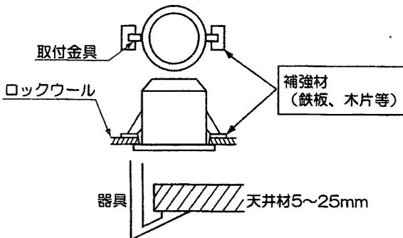
ロックウールなど柔らかい材料を使用している天井に取り付ける場合には、必ず取付金具と天井材との間に補強材(鉄板、木片等)を入れてください。
