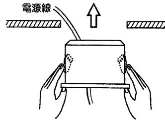
③枠を天井面に押し当てながら取付金具を引き上げます。
