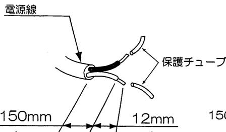
②電源線を電源用端子台のゲージ (12mm) に合わせます。
