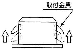
②取付金具を押さえながら電源線を通し天井内に挿入します。
