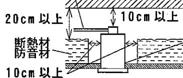
断熱材・防音材で本体の放熱孔穴等をふさがないでください。
