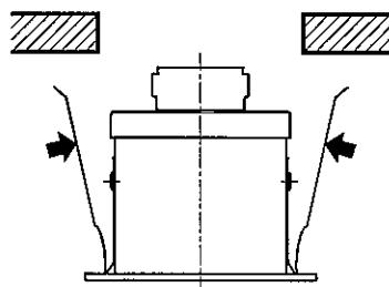
①取付金具を押さえながら取付穴に押し込めます。
