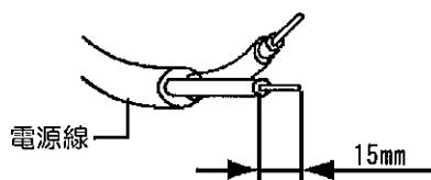
②電源線を電源用端子台に差し込みます。
