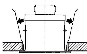
③天井内で取付板ばねが開き器具が固定されます。
