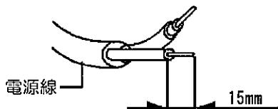
②電源線を電源用端子台に差し込みます。
