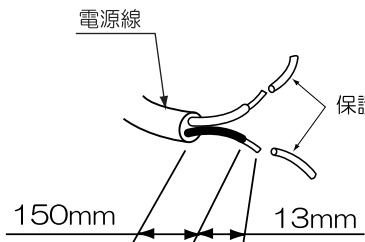
②電源線を電源用端子台のゲージ（13mm）に合わせます。
