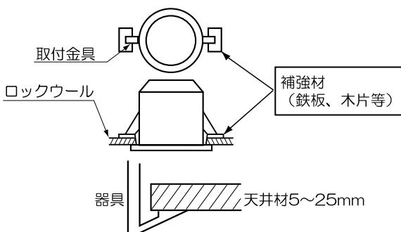
ロックワールなど柔らかい材料を使用している天井に取り付ける場合には、必ず取付金具と天井材との間に補強材(鉄板、木片等)を入れてください。
