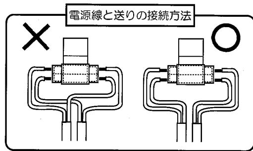
**△注意** **!** 端子台に差し込むケーブルは必ずVVF $\phi$ 1.6または $\phi$ 2.0の単線ケーブルで真っ直ぐな線を使用してください。
