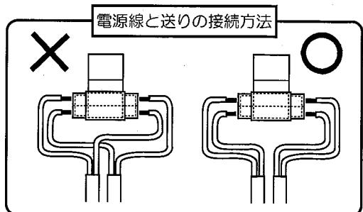
**△注意** **!** 端子台に差し込むケーブルは必ずVV-F  $\phi$  1.6または $\phi$  2.0の単線ケーブルで真っ直ぐな線を使用してください。
