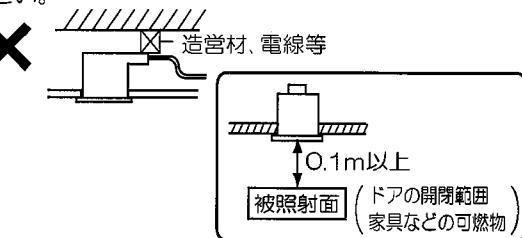
などの設備または屋内配線の電線ケーブルに触れないように施工してください。
