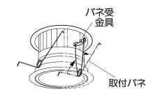
②取付バネを縮めて本体のバネ受金具に引っ掛け、 灯具を押し上げてセットします。
