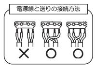
端子台に差し込むケーブルは、必ずVVFΦ1.6またはΦ2.0の単線ケーブルで真っ直ぐな線を使用してください。 ★指定以外のケーブルや曲った芯線、汚れた芯線の使用は、接触不良による火災や感電事故の原因となります。
