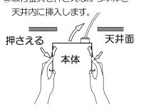
③本体を天井面に押し当てながら、 取り付け方向表示を微調整し、 取付金具を引き下げ本体を固定 します。
