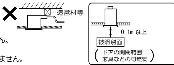
一住宅以外の断熱施工天井でご使用の場合の施工方法
