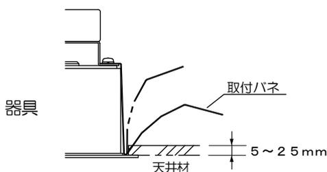
ロックウールなどの柔らかい材料を使用している天井に取り付ける場合には、必ず取り付け金具と天井材の間に補強材(鉄板・木片等)を入れてください。
