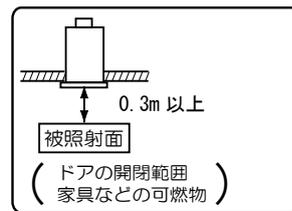
一住宅以外の断熱施工天井でご使用の場合の施工方法
