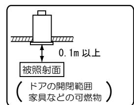
ー住宅以外の断熱施工天井でご使用の場合の施工方法ー
