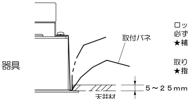
ロックウールなどの軟らかい材料を使用している天井に取り付ける場合には、必ず取付バネと天井材の間に補強材(鉄板・木片等)を入れてください。
