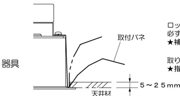
ロックウールなどの柔らかい材料を使用している天井に取り付ける場合には、必ず取付バネと天井材の間に補強材(鉄板・木片等)を入れてください。
