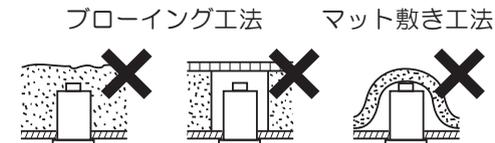
住宅以外の断熱施工天井でご使用の場合の施工方法
