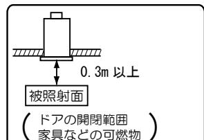
一住宅以外の断熱施工天井でご使用の場合の施工方法
