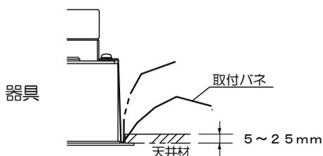
ロックウールなどの柔らかい材料を使用している天井に取り付ける場合には、必ず取り付け金具と天井材の間に補強材(鉄板・木片等)を入れてください。
