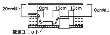
電気配線は断熱材・防音材の上側にくるよう配線してください。
