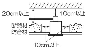
電気配線は断熱材・防音材の上側になるように配線してください。
