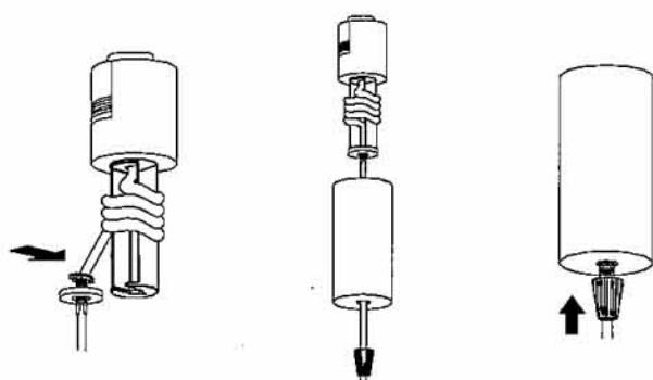
①フランジ固定ナットを緩め、フランジ固定ナットと、フランジを静かに本体まで下ろします。
