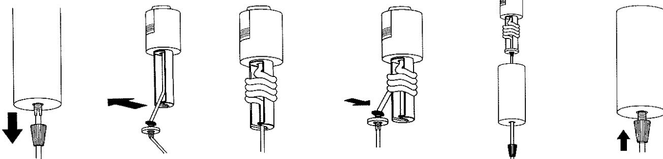
①フランジ固定ナットを緩め、フランジ固定ナットと、フランジを静かに本体まで下ろします。
