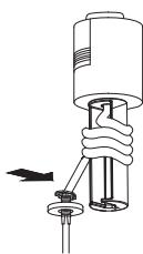
5. フランジの孔をコード止めに合わせいれ、フランジ固定ナットで締め込みフランジを固定してください。
