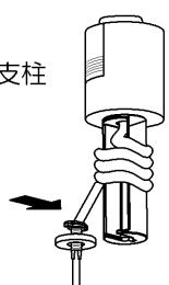
5. フランジの孔をコード止めに合わせいれ、フランジ固定ナットで締め込みフランジを固定します。
