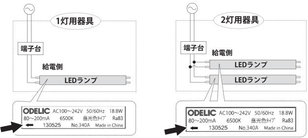
※ランプの「◆」表示を給電側ソケットに接続してください。
