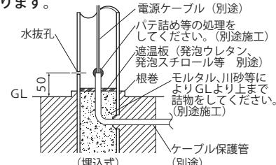
必ずコンクリート等で、ポールの埋込部を補強してください。
