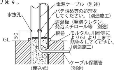
必ずコンクリート等で、ポールの埋込部を補強してください。ポール地際部は防錆の為、必ずコンクリート根巻してください。その時、埋込み表示ラベル上にある水抜孔は塞がないでください。地際部は、腐食しやすいので少なくとも3~5年に1回、出来れば年1回程度必ず定期的に点検をし、もし腐食が見られる場合速やかに補修、または交換をお願いします。
