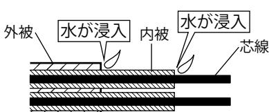
キャブタイヤケーブルを切断して他のケーブル等を接続する際は、接続部を市販のジョイントボックスに収めてください。
