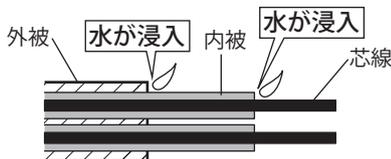
キャブタイヤケーブルを切断して他のケーブル等を接続する際は、接続部を市販のジョイントボックスに収めてください。ジョイントボックスを使用しない場合、ケーブル接続部からの浸水による絶縁不良やLED不点灯の原因になります。
