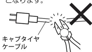
キャブタイヤケーブルを切断すると外被や内被のすき間から灯具内部へ水が浸入し、絶縁不良やLED不点灯の原因になります。
