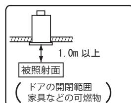
一住宅以外の断熱施工天井でご使用の場合の施工方法
