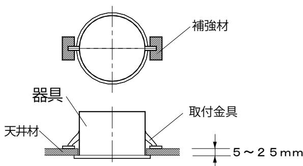
ロックウールなどの軟らかい材料を使用している天井に取り付ける場合には、必ず取付バネと天井材の間に補強材(鉄板・木片等)を入れてください。
