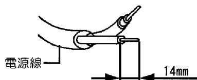
②電源線を電源用端子台に差し込みます。
