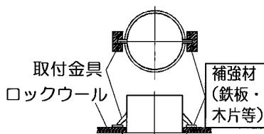
ロックワールなどの軟らかい材料を使用している天井に取り付ける場合には、必ず取り付け金具と天井材の間に補強材（鉄板・木片等）を入れてください。
