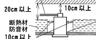
断熱材・防音材で本体の放熱孔穴等をふさがないでください。
